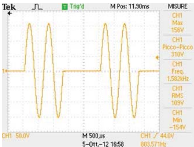
Fig. 5 Vpp: 310 - Fr: 2 kHz - 500 µs/div
