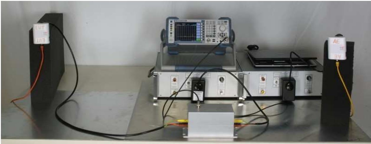
Abb. 8: Praktischer Messsaufbau nach Kapitel 9.4 EN-50561-1, Abbildung 6 Fig. 8: Practical measurement setup according to EN-50561-1, chapter 9.4, fig. 6
